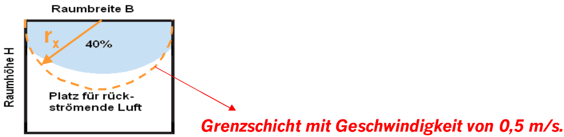
Abbildung 7 Raumquerschnitt in Luftrichtung
