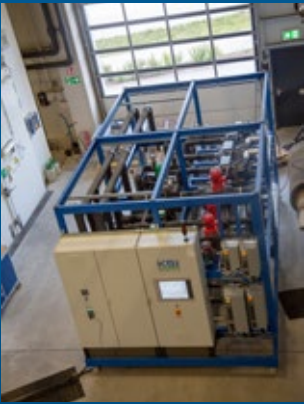
▲ Klare Leistungsangaben, z. B. für Verflüssigungssätze oder Verkaufskühlmöbel, liefert der leistungsfähige CO 2 -Prüfstand des TÜV SÜD in Olching.
