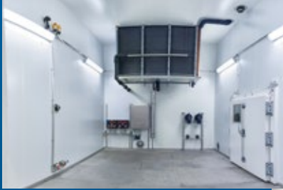
▲ In den Prüfkammern können Raumtemperaturen zwischen -40 °C und +50 °C eingestellt werden und dies bei relativen Luftfeuchten zwischen 20 und 95 %.
