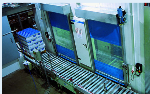
Kühltunnel – Jogurtabkühlung von 20/25 °C auf 6 °C, 50 Paletten pro Stunde
