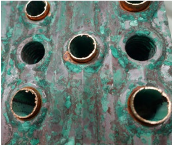
Fig. 2: Lamas de cobre con una pátina verde muy pronunciada que ha creado una capa exterior protectora muy adherida.
